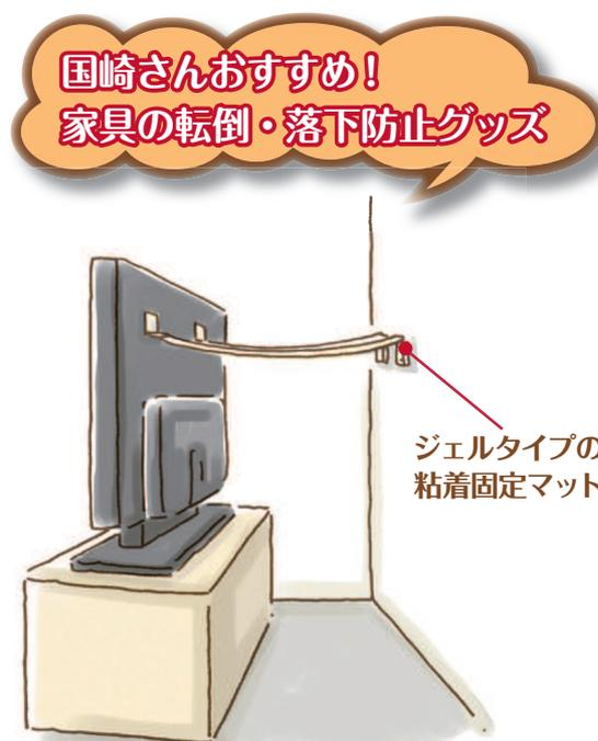
▲ジェルタイプの粘着固定マットは、壁に傷をつけずに家具類を固定できるものがあり、賃貸住宅でも使用が可能です。重量が100kgまでの大型家具に対応しているものもあり、薄型大画面テレビは、背面と粘着固定マットを貼った壁をベルトで固定して転倒を防止します。
