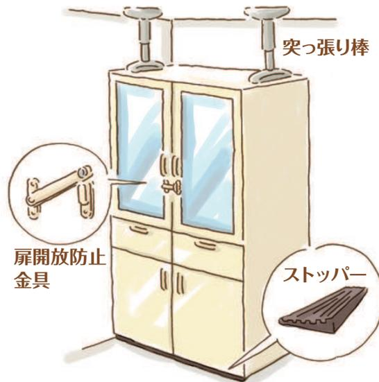
◀壁に固定するし字金具などが使えない場合、突っ張り棒とストッパーの2種類の器具を上部、下部の2カ所で併用すると効果的。
