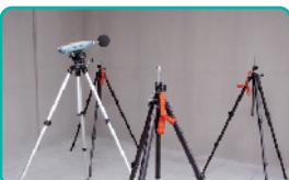
▲301号室／試験室レベルで上下階の床騒音(遮音)対策の検討
