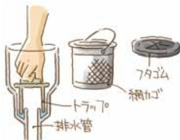
フタゴムと網カゴを取り外した後に、排水管にかぶせてあるトラップを回して引き上げる。
