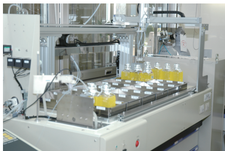
▲水質自動計測装置 飲料水中の有機物の量、pH値、色や濁りを自動で測定する装置
