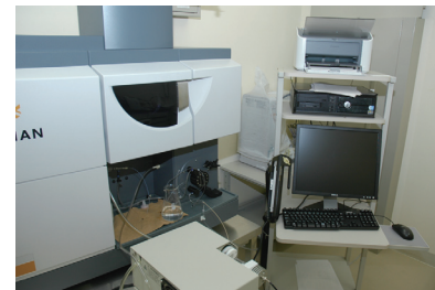
▲高周波プラズマ発光分析器 健康を害するカドミウムや六価クロム等金属類を計測します
